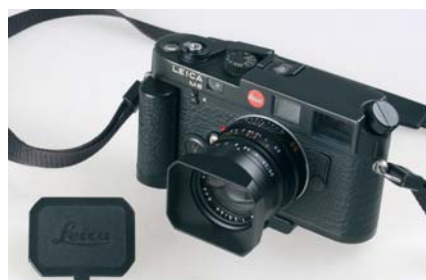
C'è paraluce e paraluce: questo di Leica, specificatamente disegnato per gli obiettivi Summarit 35mm e 50mm, si rivela una barriera efficace nei confronti di gocce d'acqua e "polpastrelli vaganti". Anche in questo caso però un filtro di protezione è comunque gradito, ed infatti l'abbiamo montato. Non fosse altro che per il valore dell'ottica.
